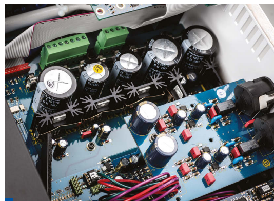
Płytkę symetrycznego toru wyjściowego dla gniazd XLR i sekcji zasilania (powyżej).
